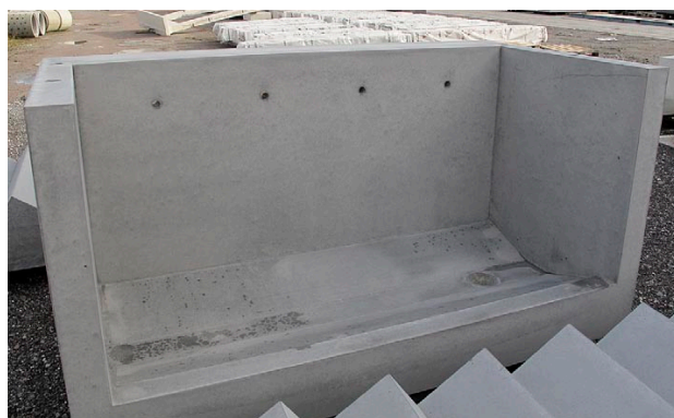
Élément type C2 après le décoffrage
