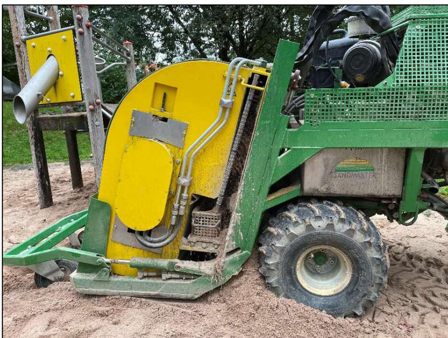
**Abb. 2-1: Das Sandreinigungsgerät der Fa. Sandmaster**
