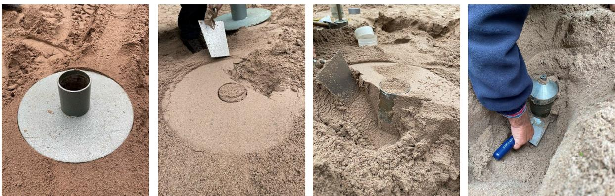
**Abb. 3-2:** Entnahme von Sandproben mit Hilfe eines Stechzylinders
