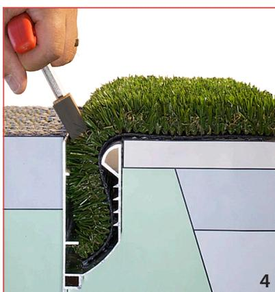
4 Das Befestigungselement wird mittels Einbauschlüssel in das Einbauelement eingeführt.
