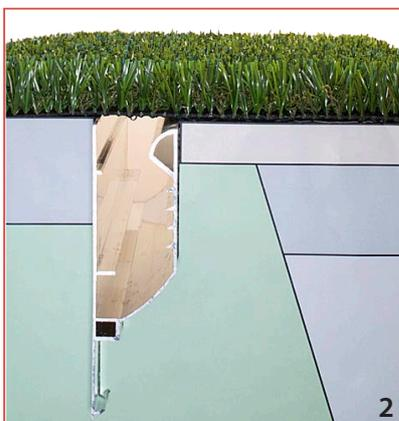
2 Der Kunstrasen wird überlappend auf das eingebaute Kunstrasen-Einbauelement verlegt und nach Bestimmung der Einbaulänge (temperaturabhängig) zugeschnitten.
