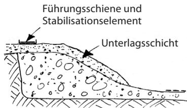
Nach dem Aufschütten der Ausgleichsschicht werden alle Führungsschienen (inkl. Stabilisationselemente) höhengerecht (2 cm unter OK) verlegt. Die Elementstärke beträgt 3 cm und die Erfahrung zeigt, dass eine Senkung von mindestens 1 cm realistisch ist.
