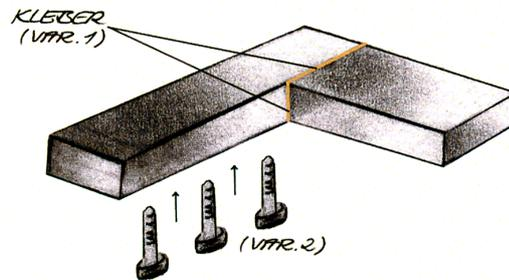
**Variante 2:** Die EUROFLEX® Blockstufe können Sie auch, ohne Verklebung mit dem Untergrund, direkt auf Frischbeton (B 15) versetzen. Dazu drehen Sie mehrere verzinkte Sechskantschrauben 10 x 200 mm, mind. 7 cm tief in den Gummi und setzen Sie die Blockstufe mit dem Schraubkopf in den Frischbeton ein. Verkleben bzw. verfugen Sie die Stöße der Blockstufen miteinander.
