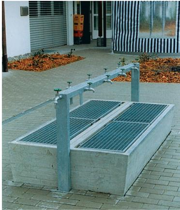
! Die Leitung hält einem Betriebsdruck von maximal 6 bar stand. Sofern ein erhöhter Druck vorhanden ist, muss bauseits ein Druckreduzierventil eingebaut werden. Die Leitung muss bei Frostgefahr entleert werden!
